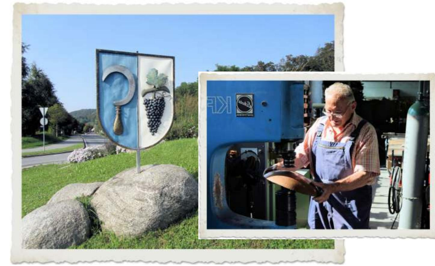
Herstellen einer Kupferschale an E-Koldmaschine
